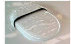
Entrada de ar pelo teto, parte externa do veículo.
