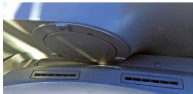
Detalhe da tampa do acesso ao mecanismo pelo painel do veículo
