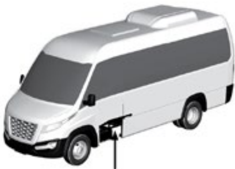
Acesso à central elétrica PWR1
