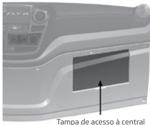
Tampa de acesso à central elétrica PWR2
