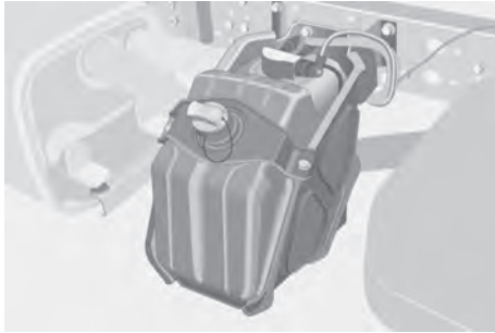
Reservatório de ARLA32
