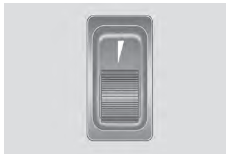
Potenciômetro de regulagem da iluminação dos interruptores
