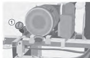
1- Bocal de abastecimento de óleo, na parte frontal do veículo
