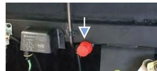
A válvula de emergência externa está localizada na frente do veículo, dentro do capô dianteiro.
