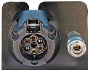
O veículo dispõe de uma tomada elétrica dianteira para possibilitar o acionamento das luzes de posição, luzes de freio e luzes indicadoras de
