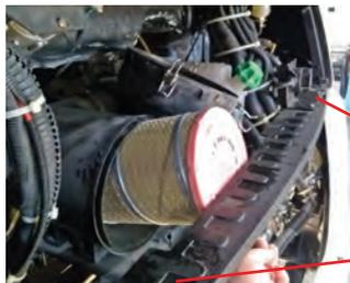
Para realizar a manutenção do filtro de ar solte os parafusos da travessa superior do para-choque nas duas extremidades e remova a travessa.
