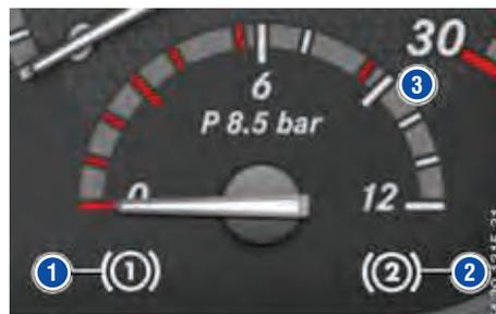
O circuito do freio com menor pressão de reserva é indicado pela luz de controle **(1)** ou **(3)**. O indicador **(2)** indica a pressão neste circuito de freio.
