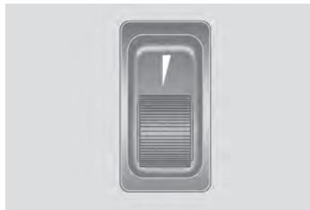
Potenciômetro de regulagem da iluminação dos interruptores
