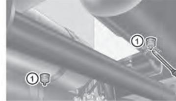
Drenagem manual dos reservatórios pneumáticos (exemplo)
