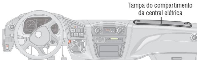
A central elétrica contém todos os relés e fusíveis que compõem o sistema elétrico, e ainda contém conectores e chicote elétrico.
