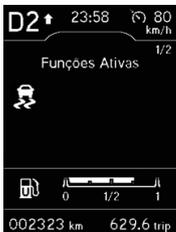
Para situações de arrancadas em solo escorregadio, ou subidas íngremes o veículo conta com um sistema chamado ASR (Anti-Slip Regulator), que impede a derrapagem do veículo durante a arrancada, por meio do controle do torque do motor ou freando a roda de tração que está sobre o efeito da derrapagem. Quando este sistema estiver atuando, poderá aparecer a sigla “ASR” na tela de funções do computador de bordo conforme figura ao lado.
