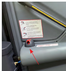
A válvula de emergência interna está localizada junto à porta
