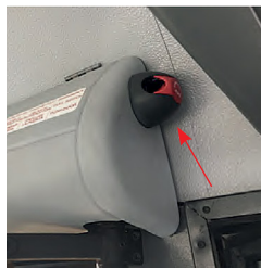
A válvula de emergência interna está localizada em cima da porta
