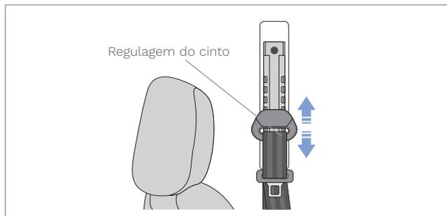
Para ajustar a altura pressione o suporte do cinto para dentro, para destravar, mantenha pressionado, posicione na altura desejada e depois solte e verifique seu travamento.
