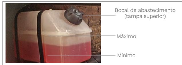
O sistema de arrefecimento deve receber água desmineralizada limpa, isenta de impurezas e adicionado com anti-corrosivo. Desta maneira evita-se a formação de incrustações, que com o tempo formarão uma camada em torno das camisas, não permitindo a dissipação de calor, trazendo com isso um mau funcionamento do motor.
