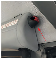
A válvula de emergência interna está localizada em cima da porta
