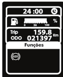
Para situações de arrancadas em solo escorregadio, ou subidas íngremes o veículo conta com um sistema chamado **ASR (Anti Slip Regulator)**, que impede a derrapagem do veículo durante a arrancada, por meio do controle do torque do motor ou frenando a roda de tração que está sobre o efeito da derrapagem. Quando este sistema estiver atuando, poderá aparecer a sigla “**ASR**” na tela de funções do computador de bordo conforme figura ao lado.
