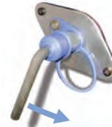
A chave geral mecânica está localizada na caixa de bateria; em caso de emergência, segurança ou manutenção, imobiliza o veículo desligando todos os equipamentos elétricos, com exceção das funções do motor de partida, cronotacógrafo, emergência, sistemas com memória alimentada, rádio e portas.
