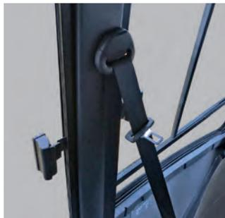
O veículo vem equipado com cinto de segurança retrátil tipo “3 pontos”, para o condutor e condutor auxiliar.
