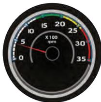
Seu veículo está equipado com tacômetro eletrônico que indica as rotações por minuto do motor.
