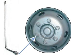
d) Remova as porcas e retire a roda com cuidado para não danificar a rosca dos parafusos;
