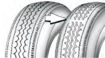
Os pneus devem ser substituídos quando o desgaste da banda de rodagem atingir os indicadores existentes no fundo dos sulcos, ou ainda quando apresentarem corte, deformações ou outros danos.
