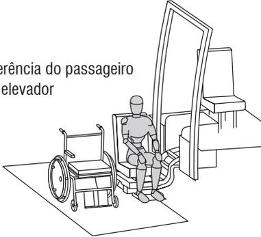
11. Com o passageiro em uma posição segura, pressionar a botoeira “SOBE” do controle remoto até que a poltrona atinja o nível das demais poltronas e o elevador se desligue automaticamente.
