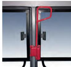
Os veículos, com janelas fixadas com borrachas, são equipados com saídas de emergência junto as janelas do salão. Em caso de emergência, puxe as duas alavancas (1) e empurre a janela usando ambas as mãos.
