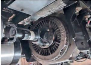
Caso seu veículo esteja equipado com o conjunto retarder como dispositivo de freio auxiliar, a correta utilização deste poderá reduzir consideravelmente o desgaste dos componentes do sistema de freio.
