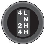
Quando a tração nas 4 rodas for engatada, a força de tração também é fornecida as rodas dianteiras através da caixa de transferência.
