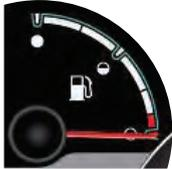
Este indicador mostra o nível de combustível existente no tanque. Além das indicações de vazio e cheio, o instrumento indica também  $\frac{1}{4}$ ,  $\frac{1}{2}$  e  $\frac{3}{4}$  da capacidade total de combustível no tanque.
