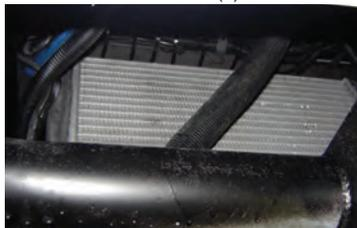
Ao operar em condições de muita poeira, efetue a limpeza das colméias com maior frequência. Utilize jatos de ar comprimido, evitando pressão excessiva que possa danificar as aletas. Dirija o jato de trás para a frente, pois a sujeira tende a ficar bloqueada pela frente das colméias.
