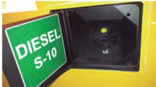
Nos modelos Attack 8 o tanque de combustível está localizado no entre-eixo do veículo, e o bocal de abastecimento no lado esquerdo, sendo que no modelo 4X4 o bocal de abastecimento está no lado direito e o tanque no balanço traseiro, entre longarinas.
