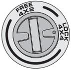
Com o veículo parado com freio estacionário acionado, retorne da posição "LOCK" 4x4 (tração das rodas dianteiras engatadas) para a posição "Free" 4x2 (tração das rodas dianteiras desengatadas), ou seja, girando a tampa (1) no sentido anti-horário.
