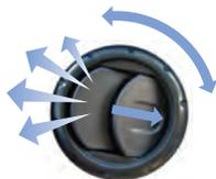
Os difusores de ar estão localizados no painel, são acionados através da chave de ventilação e permitem o direcionamento de ar para o posto do condutor e auxiliar através de suas aletas.
