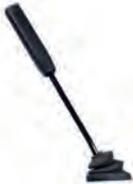
A alavanca de acionamento do freio retarder possui três estágios de atuação. Os estágios definem a capacidade de frenagem, que aumenta proporcionalmente, de acordo com o estágio em que a alavanca se encontra. A definição da posição da alavanca depende do nível de desaceleração desejada e, principalmente, da inclinação da pista de rodagem.
