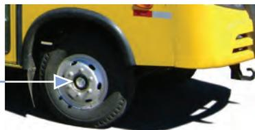
**Posição N (Neutro)** - Esta posição desengata os eixos do conjunto de força. Utilize para rebocar o veículo.
