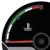
O Indicador de Temperatura do Motor registra a temperatura da água do sistema de arrefecimento do motor. Além das indicações de frio em baixo e quente em cima, e possui uma faixa vermelha que indica temperatura excessiva.
