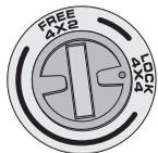
Com o veículo parado com freio estacionário acionado, retorne da posição “LOCK” 4x4 (tração das rodas dianteiras engatadas) para a posição “Free” 4x2 (tração das rodas dianteiras desengatadas), ou seja, girando a tampa (1) no sentido anti-horário.
