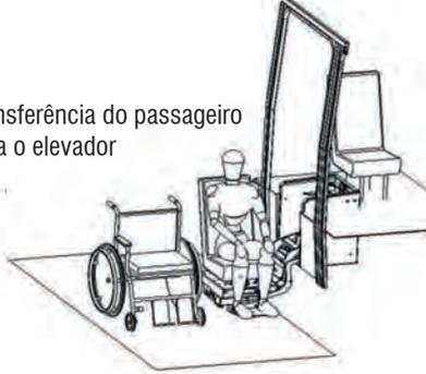
11. Com o passageiro em uma posição segura, pressionar a botoeira “SOBE” do controle remoto até que a poltrona atinja o nível das demais poltronas e o elevador se desligue automaticamente.
