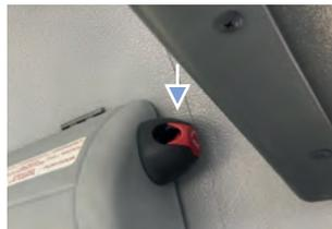
A válvula de emergência interna está localizada junto à porta.
