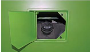
Nos modelos Attack 8 o tanque de combustível está localizado no entre-eixo do veículo, e o bocal de abastecimento no lado esquerdo, sendo que no modelo 4X4 o bocal de abastecimento está no lado direito e o tanque no balanço traseiro, entre longarinas.
