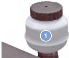
O reservatório do fluido da embreagem está localizado junto ao painel. Para acessá-lo abra a tampa superior do painel, acima do volante da direção.
