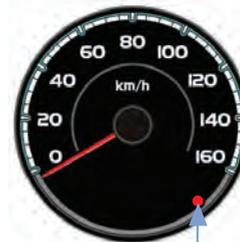
Indica a velocidade de deslocamento do veículo em quilômetros por hora (Km/h).
