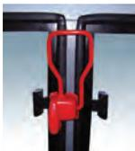
O Volare está equipado com saídas de emergência junto as janelas do salão. Em caso de emergência, puxe as duas alavancas (1) e empurre a janela usando ambas as mãos.
