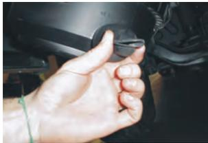
A cuba do filtro de ar está localizada na base do filtro de ar. Para a limpeza da cuba, pressione a válvula de descarga escoando a poeira e fuligem acumuladas no interior da cuba.
