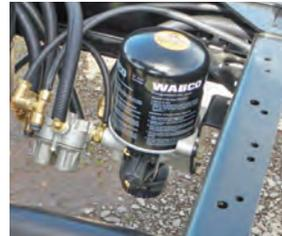
O sistema de freio é equipado com o filtro secador que retira e absorve a água condensada no circuito de freio, aumentando a durabilidade do sistema.
