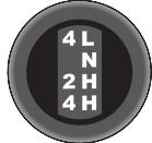
**Posição 4L (4x4 Reduzida)** - Maior força de tração aos eixos dianteiro e traseiro com maior torque e menor velocidade.
