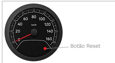
Indica a velocidade de deslocamento do veículo em quilômetros por hora (Km/h). Para veículos com tacôgrafo o ajuste do relógio é automático. Para efetuar o reset do odômetro parcial, mantenha pressionado o botão de reset até que os números comecem a piscar, após isso, solte o botão e pressione brevemente outra vez.
