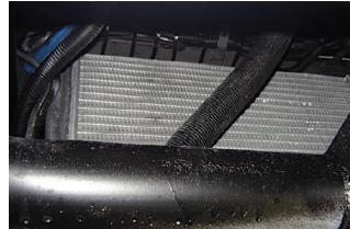
Ao operar em condições de muita poeira, efetue a limpeza das aletas com maior frequência. Utilize jatos de ar comprimido, evitando pressão excessiva que possa danificar as aletas. Dirija o jato de trás para a frente, pois a sujeira tende a ficar bloqueada pela frente das aletas.
