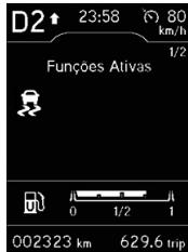
Para situações de arrancadas em solo escorregadio, ou subidas íngremes o veículo conta com um sistema chamado ASR (Anti-Slip Regulator), que impede a derrapagem do veículo durante a arrancada, por meio do controle do torque do motor ou frenando a roda de tração que está sobre o efeito da derrapagem. Quando este sistema estiver atuando, poderá aparecer a sigla "ASR" na tela de funções do computador de bordo conforme figura ao lado.
