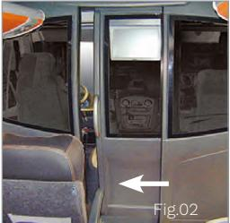
A parede de separação possui uma trava na própria porta, para abrir puxe-a para a lateral (Fig 1) e para fechar puxe-a em direção ao marco da porta (Fig 2).
