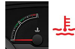
O sistema de arrefecimento está equipado com um indicador de temperatura e uma luz de aviso de superaquecimento.
