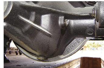
Após toda a troca de óleo e antes de colocar o veículo em operação normal, rode sem carga e limitando a velocidade em 40 km/h, de 5 a 10 minutos, ou 2 a 3 km para assegurar que todos os canais foram devidamente preenchidos com óleo lubrificante.
