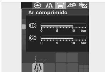
No submenu “Ar comprimido” são apresentadas as pressões de ar de reserva do circuito de frenagem 1 e do circuito de frenagem 2.
