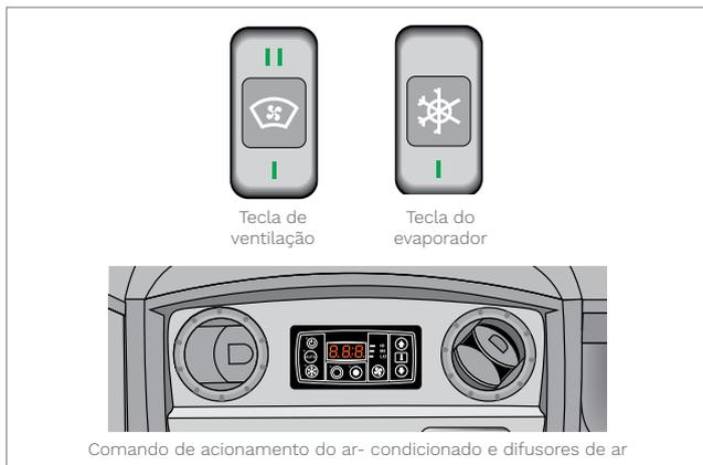
Nos modelos Volare o defroster com ar-condicionado para o condutor, localiza-se junto ao painel e permite o direcionamento do ar para o condutor e auxiliar (opcional).
