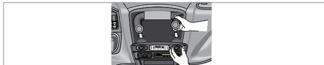
9 - Encaixe o painel central, coloque os parafusos e os acabamentos.
