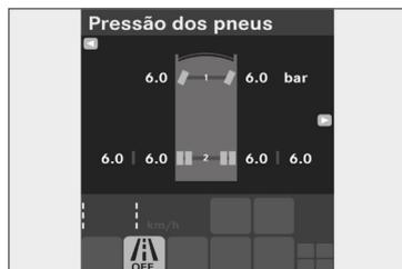
Se a pressão do pneu for reduzida ou a temperatura elevada, a cor da indicação muda de branco para amarelo ou vermelho. Devido à tolerâncias e compensação da temperatura, é possível
