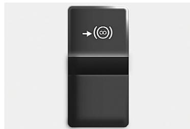
Pressione a parte inferior do interruptor do freio motor para habilitar o sistema (comando do freio motor pelo pedal do freio - ligado).
