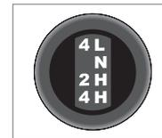
**Posição 4L (4X4 Reduzida)** - Maior força de tração aos eixos dianteiro e traseiro com maior torque e menor velocidade.
