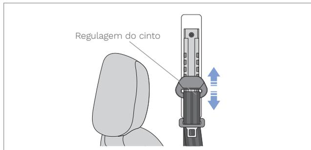
Para ajustar a altura pressione o suporte do cinto para dentro, para destravar, mantenha pressionado, posicione na altura desejada e depois solte e verifique seu travamento.
