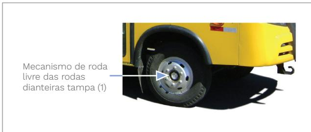
**Posição N (Neutro)** - Esta posição desengata os eixos do conjunto de força. Utilize para rebocar o veículo.
