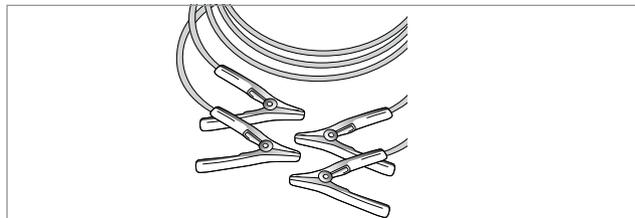
Com a ajuda de cabos auxiliares, o motor de um veículo com as baterias descarregada pode ser posto em movimento transferindo-se para ele energia das baterias de outro veículo. Isto deverá ser realizado com cuidado e obedecendo às instruções que a seguir se indicam.
