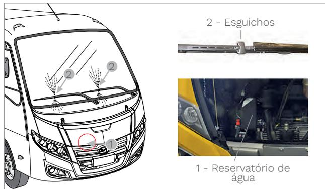
Os esguichos de água (2) se encontram na extremidade da haste, na fixação da palheta do limpador do para-brisa.
