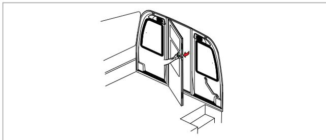
A porta da parede de separação possui um sistema de travas roletado que mantém a porta fechada. Quando aberta a porta possui um sistema de encaixe fixado junto a primeira poltrona no lado esquerdo do salão do veículo.
