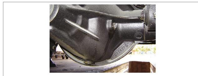
Após toda a troca de óleo e antes de colocar o veículo em operação normal, rode sem carga e limitando a velocidade em 40 km/h, de 5 a 10 minutos, ou 2 a 3 km para assegurar que todos os canais foram devidamente preenchidos com óleo lubrificante.
