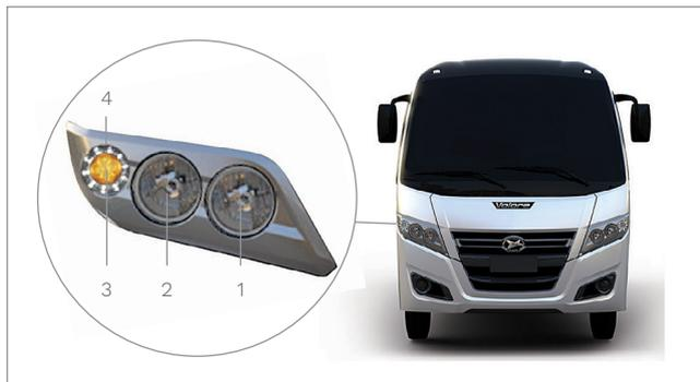
A lente externa é produzida com material plástico de alta resistência a impactos, porém deve-se tomar alguns cuidados durante a limpeza para evitar riscos e danos no farol. Vide seção “Conservação e Limpeza”.
