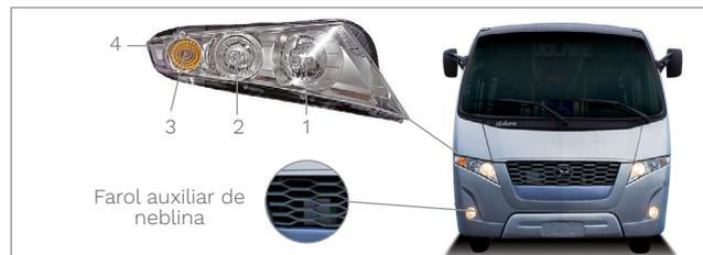
A lente externa é produzida com material plástico de alta resistência a impactos, porém deve-se tomar alguns cuidados durante a limpeza para evitar riscos e danos no farol. Vide seção “Conservação e Limpeza”
