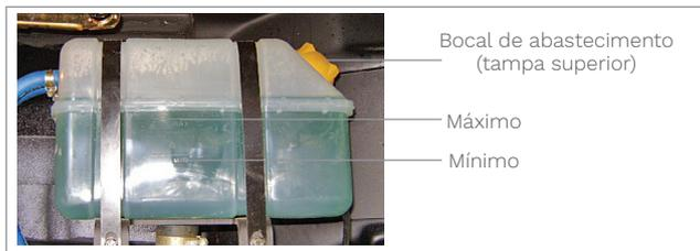
O sistema de arrefecimento deve receber água desmineralizada limpa, isenta de impurezas e adicionado com anti-corrosivo. Desta maneira evita-se a formação de incrustações, que com o tempo formarão uma camada em torno das camisas, não permitindo a dissipação de calor, trazendo com isso um mau funcionamento do motor.
