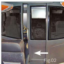
A parede de separação possui uma trava na própria porta, para abrir puxe-a para a lateral (Fig 1) e para fechar puxe-a em direção ao marco da porta (Fig 2).
