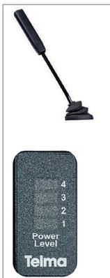
A alavanca de acionamento do freio retarder possui três estágios de atuação. Os estágios definem a capacidade de frenagem, que aumenta proporcionalmente, de acordo com o estágio em que a alavanca se encontra.
