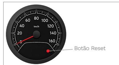
Indica a velocidade de deslocamento do veículo em quilômetros por hora (km/h). Para veículos com tacógrafo o ajuste do relógio é automático. Para efetuar o reset do odômetro parcial, mantenha pressionado o botão de reset até que os números comecem a piscar, após isso, solte o botão e pressione brevemente outra vez.
