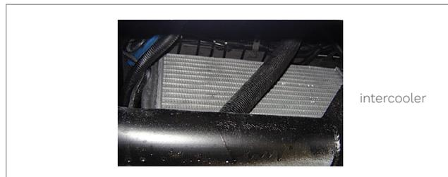
Ao operar em condições de muita poeira, efetue a limpeza das aletas com maior frequência. Utilize jatos de ar comprimido, evitando pressão excessiva que possa danificar as aletas. Dirija o jato de trás para a frente, pois a sujeira tende a ficar bloqueada pela frente das aletas.
