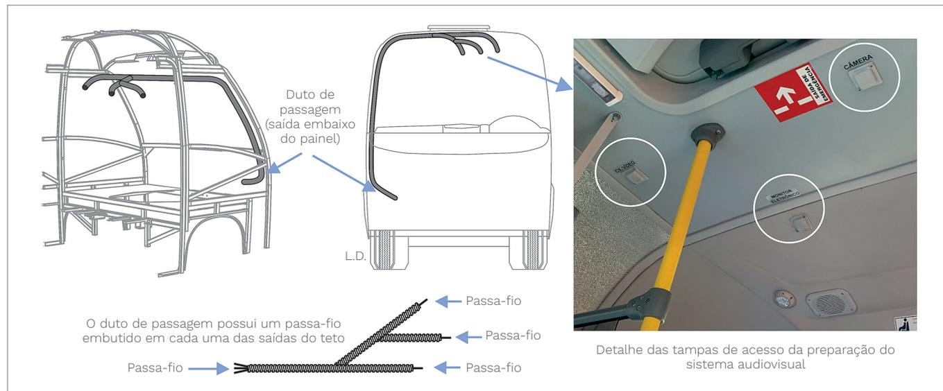
O veículo possui um duto de passagem de cabos de preparação para microcâmeras, GPS ou painel eletrônico interno, que está posicionado na coluna do lado direito.
