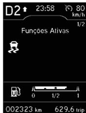
Para situações de arrancadas em solo escorregadio, ou subidas íngremes o veículo conta com um sistema chamado ASR (Anti-Slip Regulator), que impede a derrapagem do veículo durante a arrancada, por meio do controle do torque do motor ou freando a roda de tração que está sobre o efeito da derrapagem. Quando este sistema estiver atuando, poderá aparecer a sigla “ASR” na tela de funções do computador de bordo conforme figura ao lado.
