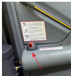
Válvula de emergência para porta com dobradiças
