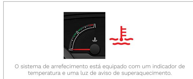
O sistema de arrefecimento está equipado com um indicador de temperatura e uma luz de aviso de superaquecimento.
