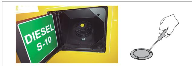
Quando necessário, o combustível pode ser drenado completamente do tanque removendo-se o bujão de dreno.
