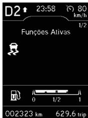
Para situações de arranadas em solo escorregadio, ou subidas íngremes o veículo conta com um sistema chamado ASR (Anti-Slip Regulator), que impede a derrapagem do veículo durante a arrancada, por meio do controle do torque do motor ou frenando a roda de tração que está sobre o efeito da derrapagem. Quando este sistema estiver atuando, poderá aparecer a sigla "ASR" na tela de funções do computador de bordo conforme figura ao lado.
