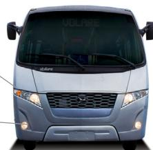
A lente externa é produzida com material plástico de alta resistência a impactos, porém deve-se tomar alguns cuidados durante a limpeza para evitar riscos e danos no farol. Vide seção “Conservação e Limpeza”
