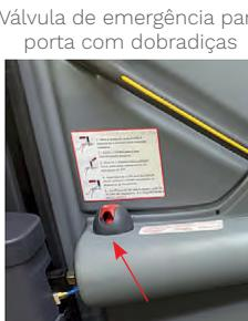
Válvula de emergência para porta com dobradiças
