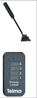
A alavanca de acionamento do freio retarder possui três estágios de atuação. Os estágios definem a capacidade de frenagem, que aumenta proporcionalmente, de acordo com o estágio em que a alavanca se encontra.
